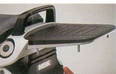
Mit einem Topcase ausrüstbarer integrierter Gepäckträger hinten.
